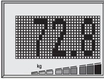
② Después de la identificación automática de personas sigue inmediatamente una indicación alternante del componente de grasa corporal (☹), del componente de agua corporal (≅) y del componente de músculos (☹). Además una indicación de tendencia según sus ajustes previos. La zona normal de cada persona está en los 3 segmentos del medio.
