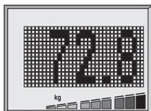
② Nach automatischer Personenerkennung erfolgt - im 5 Sekunden-Takt - die Anzeige des Körpergewichts, des Körperfettanteils (☹), des Körperwasseranteils (≈) und des Muskelanteils (☺). Der Normalbereich der jeweiligen Person liegt in den mittleren 3 Segmenten.
